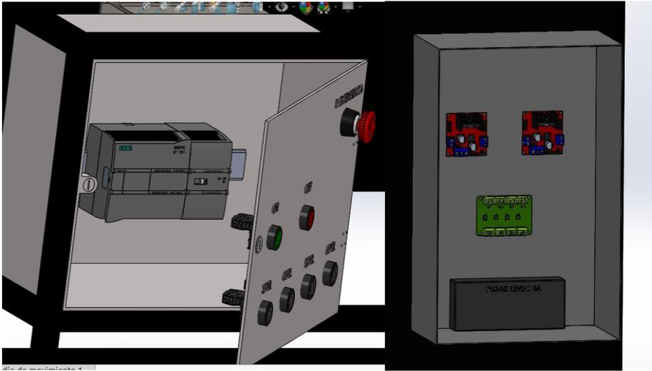
*Figura 71. Diseño caja de control y caja de circuito electrónico en SolidWorks*
