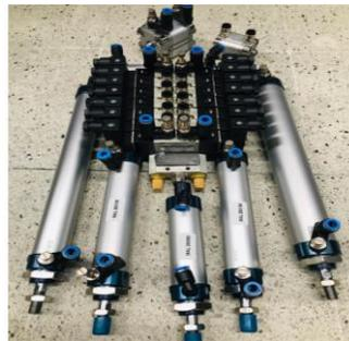
*Figura 30. Ensamblajes actuadores neumáticos*
