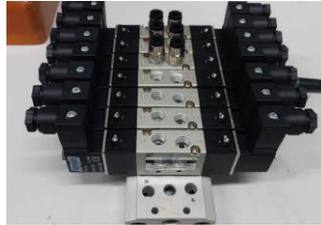
*Figura 29. Ensamble banco de electroválvulas.*
