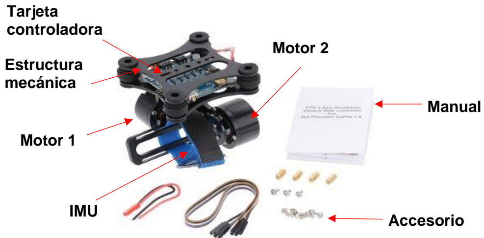
Figura 49. Gimbal FPV de 2 ejes adquirido [47]
