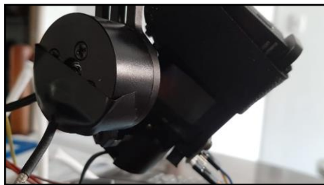
Figura 76. Sujeción Sonda para medir la temperatura del Motor
