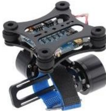
Figura 5. Gimbal FPV de 2 ejes [13]
