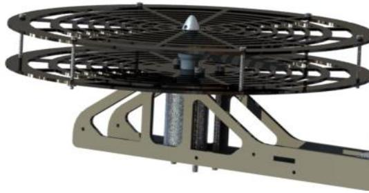
Figura 13. Vista isométrica del soporte acoplado a las rejillas de protección. La viga principal se encarga de soportar el peso del conjunto motores y del contrapeso con una longitud total desde el contrapeso hasta los motores de 127 cm. El contrapeso posee una inclinación de +46 grados con la horizontal, donde aparecen dos componentes de peso adicionales, permite aumentar el torque efectivo de este con respecto a la base, disminuyendo el esfuerzo de los motores.
