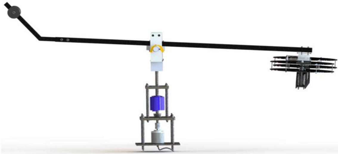
Figura 10. Vista lateral del helicóptero de 3 GDL.
