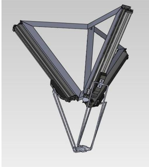
Fig. 10: Robot Delta Lineal tipo Keeps
