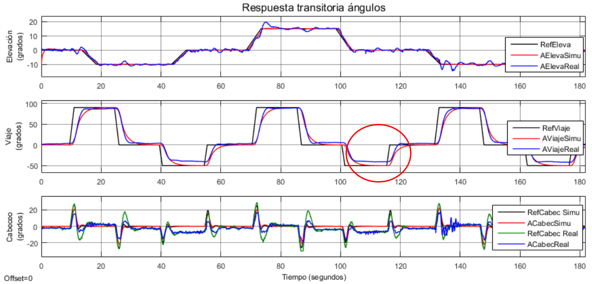
Figura 81. Validación del controlador QFT sin corrección de offset .
