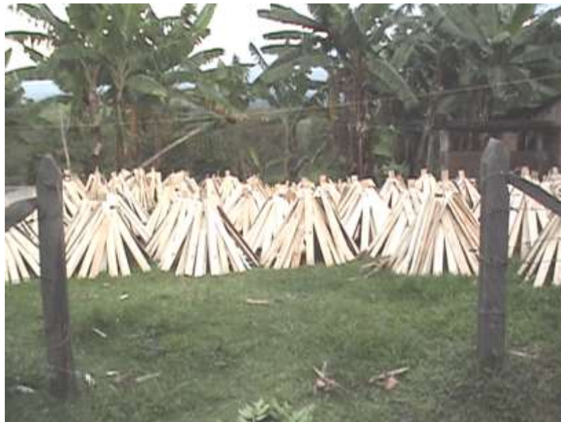
Figura 11. Proceso de secado para las cajas utilizadas en el empaque del bocadillo
