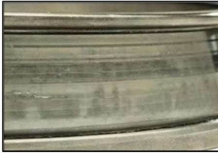
Figura 19. Falla en rodamiento por mala lubricación
