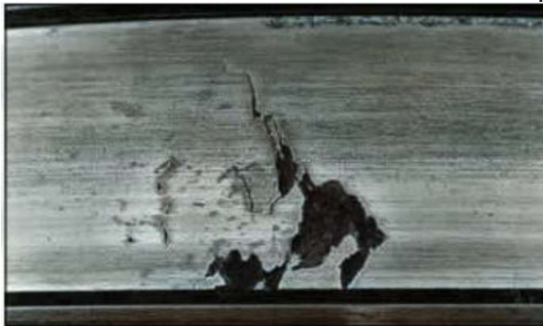
Figura 20. Falla en rodamiento por contaminación
