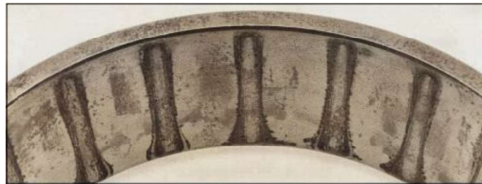
Figura 23. Falla en rodamiento por exposición al agua
