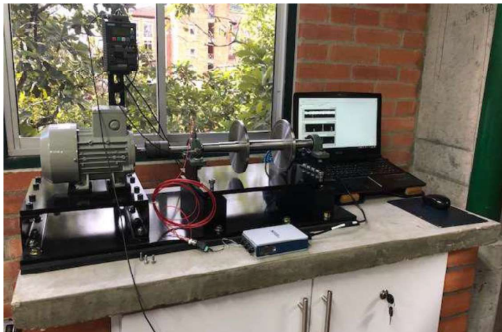
Figura 1. Banco de pruebas para simular vibraciones mecánicas en equipos rotativos
