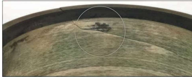
Figura 26. Falla en rodamiento por ajuste inadecuado
