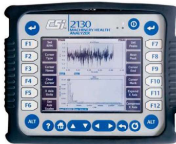
Figura 30. Equipos para toma de datos por vibraciones.
