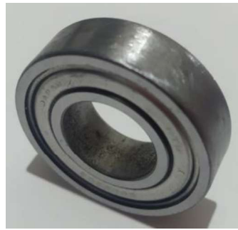
Figura 69. Rodamiento utilizado con falla externa
