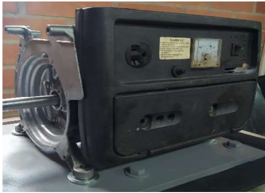
Figura 54. Generador utilizado en el banco de pruebas.
