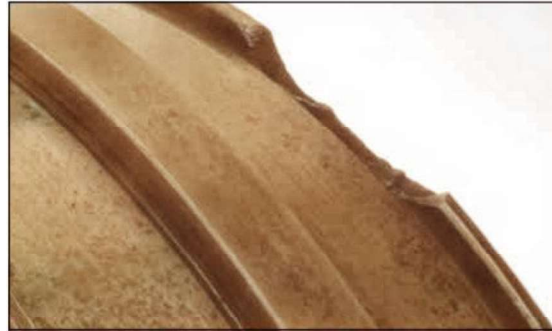
Figura 21 Falla en rodamiento por mal montaje
