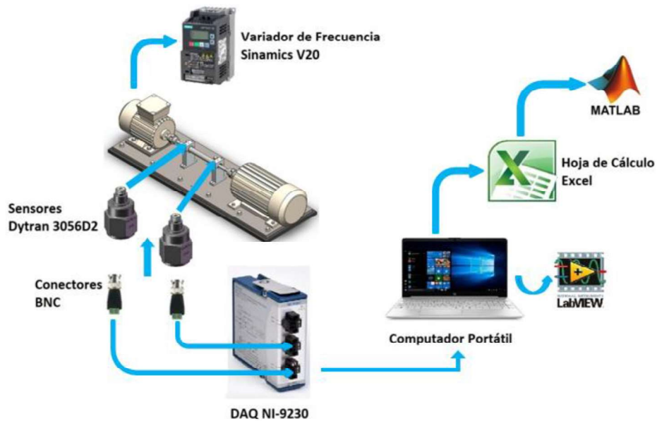
Figura 84. Montaje conexión de equipos y herramientas para la adquisición de señales.
