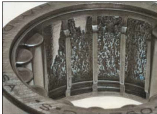
Figura 22. Falla en rodamiento por mala distribución de carga
