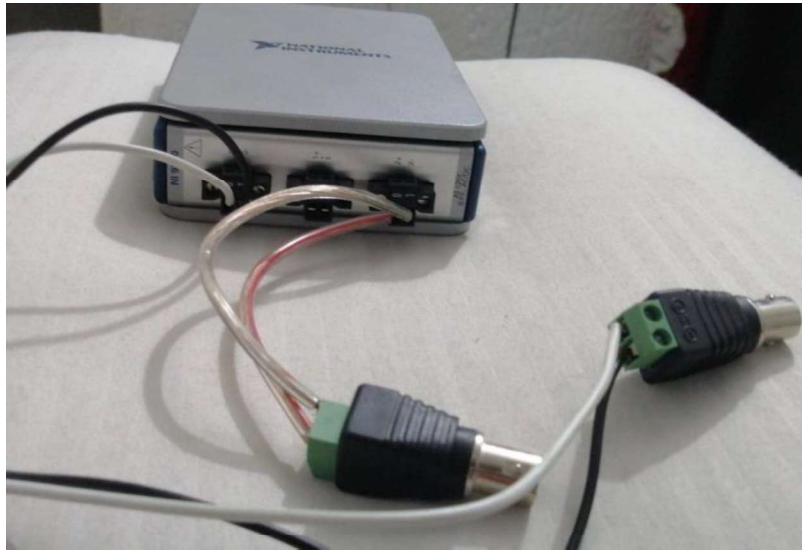
Figura 83. DAQ con acoples para cable del sensor Dytran.
