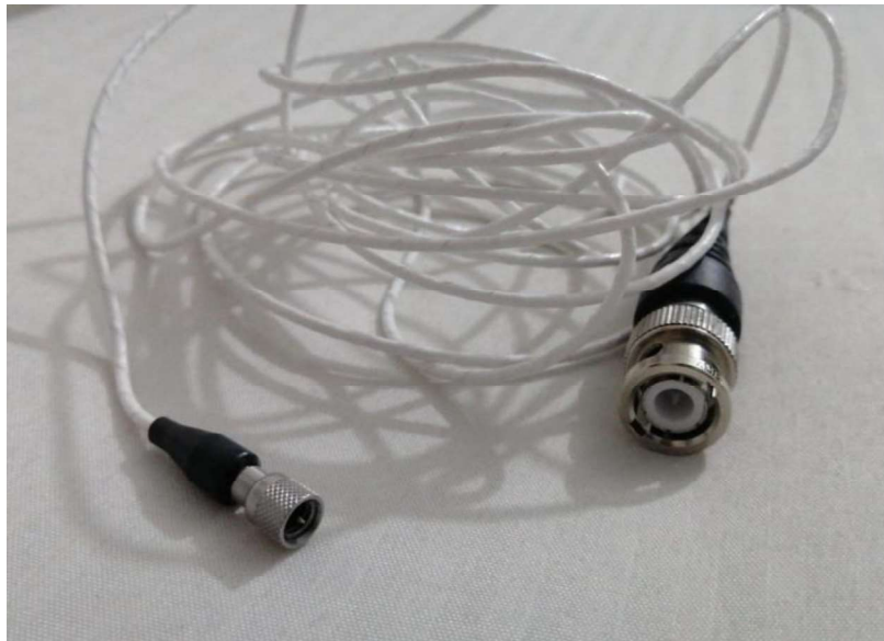
Figura 82. Tipo de conexiones del cable del sensor DYTRAN.
