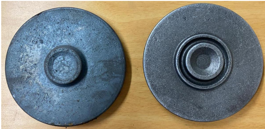
Ilustración 4 Piezas granalladas. [Autor]
