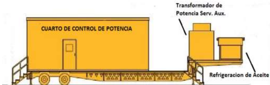
Figura 24 Cuarto de Control de Potencia T60 (PCR).
