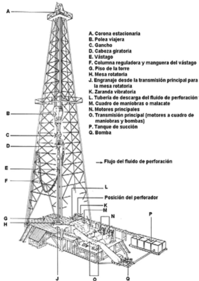
Figura 7. Esquema de un equipo de perforación
