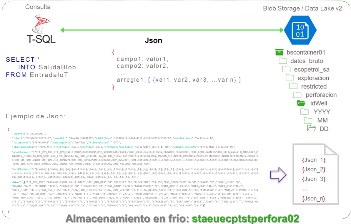
Figura 50. Configuración de la salida en frío al Blob Storage
