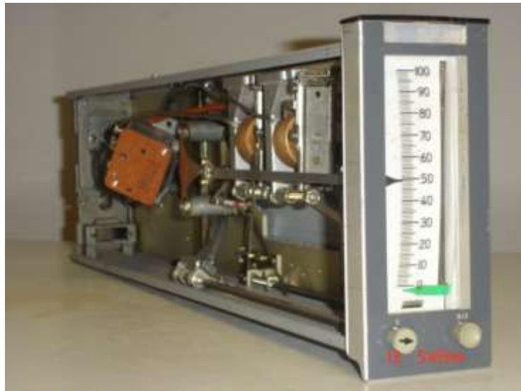
Figura 15. Controlador neumático de la B-2404, Refinería Barrancabermeja.
