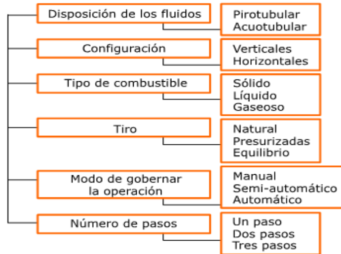
Figura 4. Clasificación de calderas.
