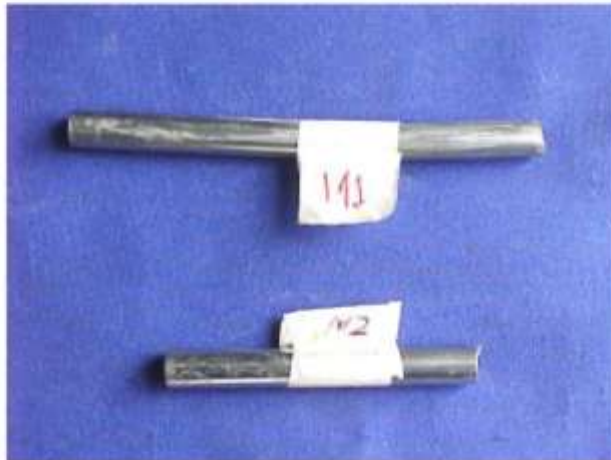
Figura 1. Muestras del tubo capilar recibidas.
