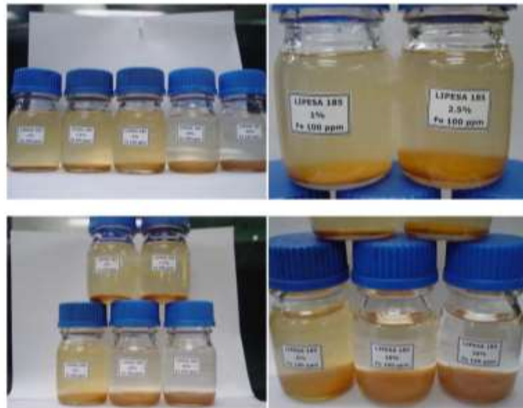
Figura 1: Aspecto de la prueba de envenenamiento con hierro (100 ppm) realizada al inhibidor de incrustaciones Lipesa-185.
