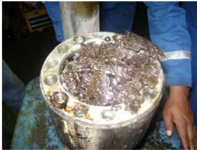
Foto 2. Precipitados de Carbonatos de Calcio la Bomba de Subsuelo.
