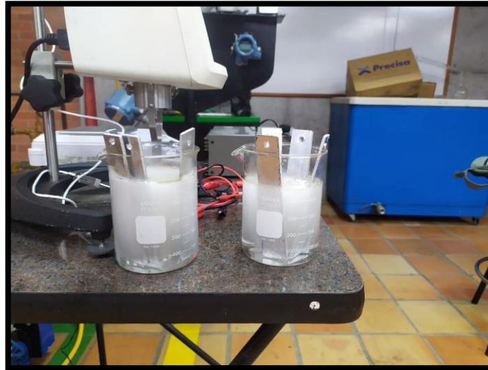
Figura 21. Decapado de aluminio mediante baño de soda caustica.
