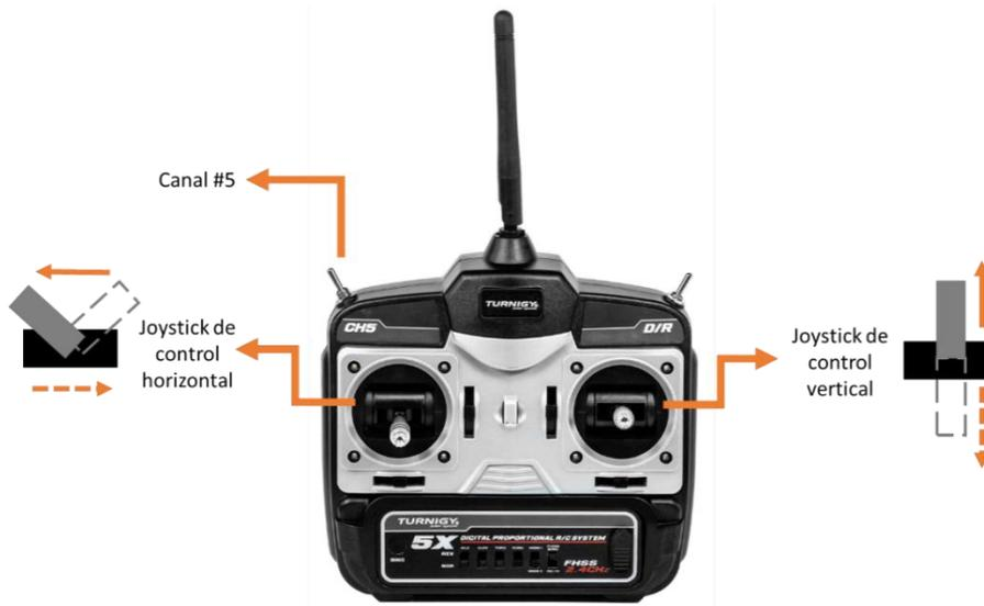
Figura 117. Comandos del modo manual por medio del radiocontrol.
