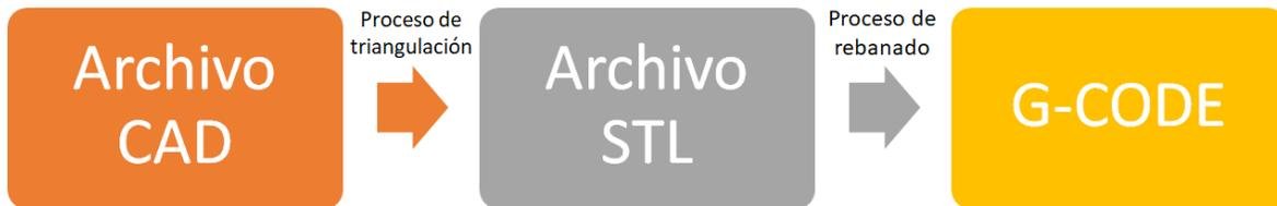
**Figura 32.** Diagrama de bloques del proceso de obtención del G-CODE.
