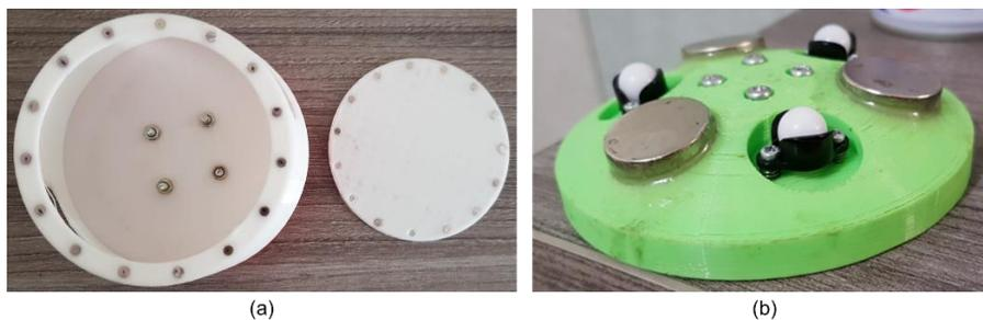
**Figura 111.** Proceso de fijación de imanes. (a) Imanes del domo. (b) Imanes del DMM.
