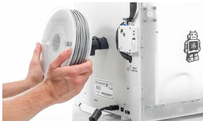
Figura 26. Bobina de filamento en la parte trasera de una impresora Ultimaker. [34]
