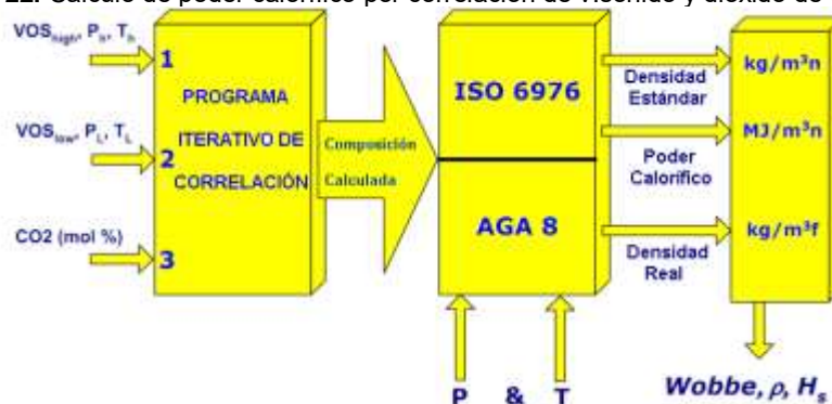
Figura 22. Cálculo de poder calorífico por correlación de v.sonido y dióxido de carbono
