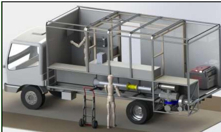
**Figura 6.** Vista interna del Vehículo adecuado para el Laboratorio móvil
