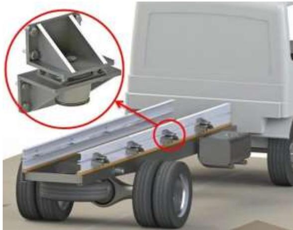
**Figura 8.** Sistemas anti vibratorios implementados en el VALM<sup>17</sup> para la reducción de impactos
