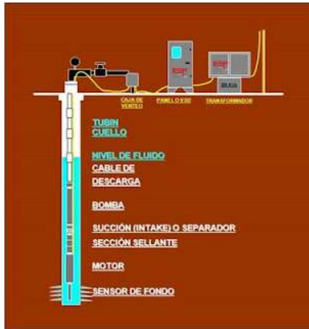
Figura 4. Esquema de un montaje de un sistema de bombeo electrosumergible. ( http://www.lacomunidadpetrolera.com/ )
