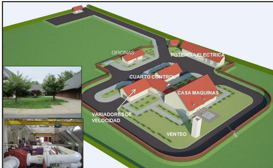
**Ilustración 13. Diseño para la estación de compresión**
