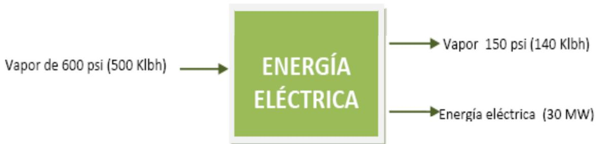
**Figura 2. Balance de Material Sección Generación Energía Eléctrica TG-2960**
