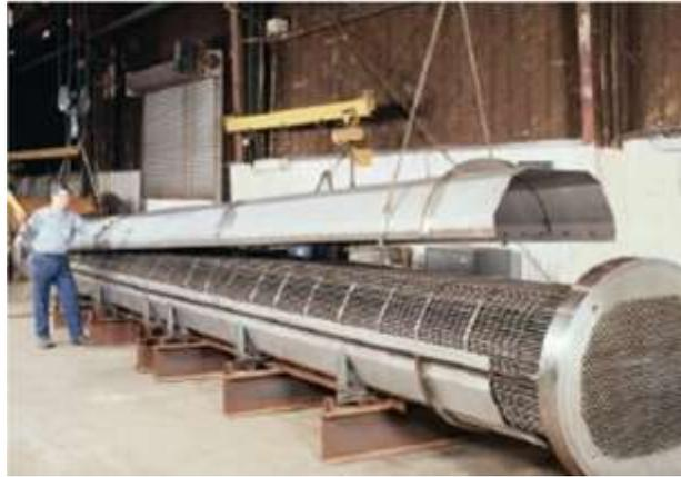
**Figura 11. Intercambiador de calor en preparación para el ensamble**
