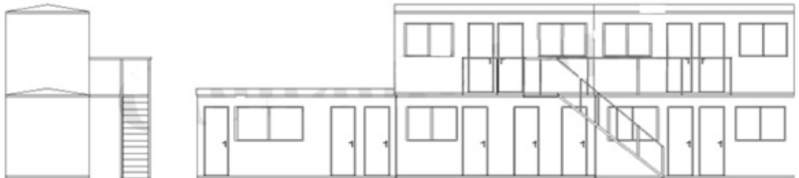
Figura 24. Corte Perfil del campamento con alojamientos agrupados en dos niveles
