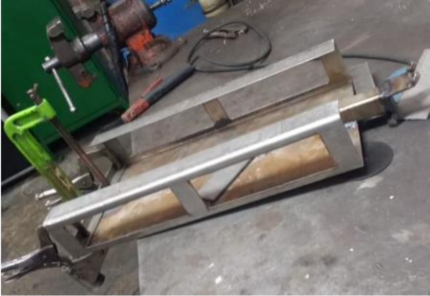
Figura 43. Avance estructural chasis.
