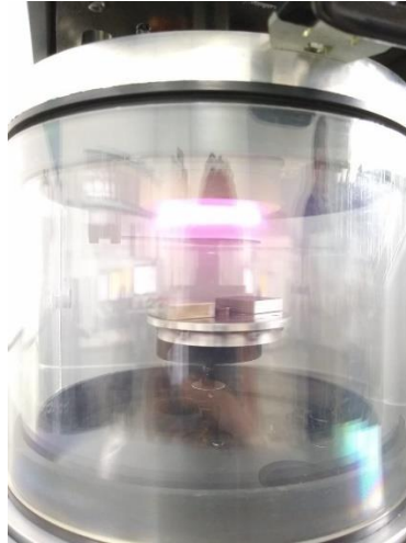
Figura 38. Recubrimiento de oro a la pieza de aluminio. [Autor]
