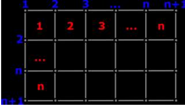
Fig. 5. Malla con elementos y nodos Fuente: Autores
