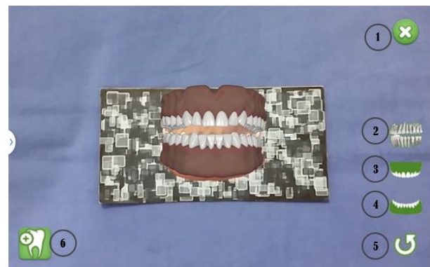
Figura 14. Funcionalidades de interactividad en la aplicación. 1) Botón de cerrar aplicación. 2) Botón para visualizar/ocultar encías. 3) Botón para visualizar/ocultar arcada superior 4) Botón para visualizar/ocultar arcada inferior. 5) Botón de resetear modelo a un estado inicial. 6) Funcionalidades de contenido de la aplicación.
