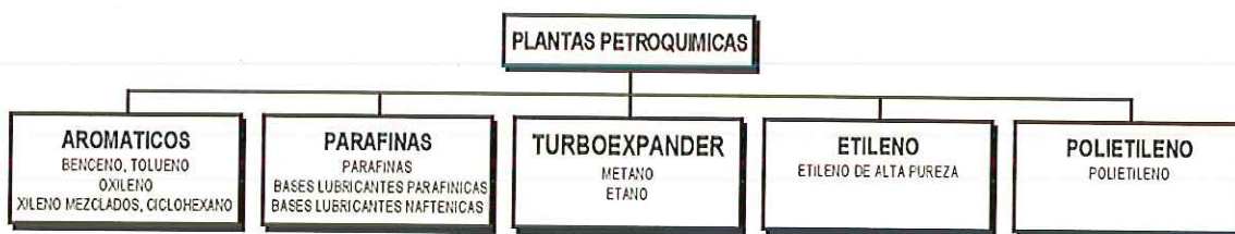
Figura 1.1 Esquema simplificado de las Plantas Petroquímicas
