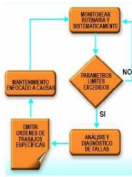
Figura 1. Proceso de Mantenimiento basado en Condición [12].
