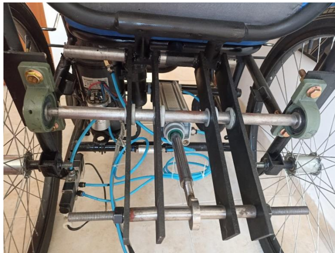
Figura 65. Ubicación de los eslabones 4 unidos al cilindro
