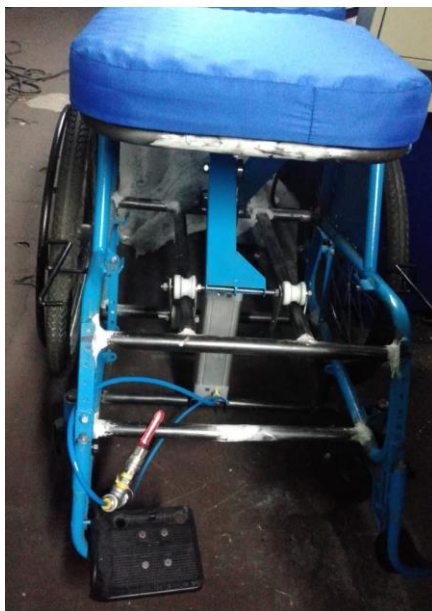
Figura 62. Mecanismo de elevación de tijeras
