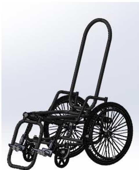
Figura 35. Sistema en posición de silla
