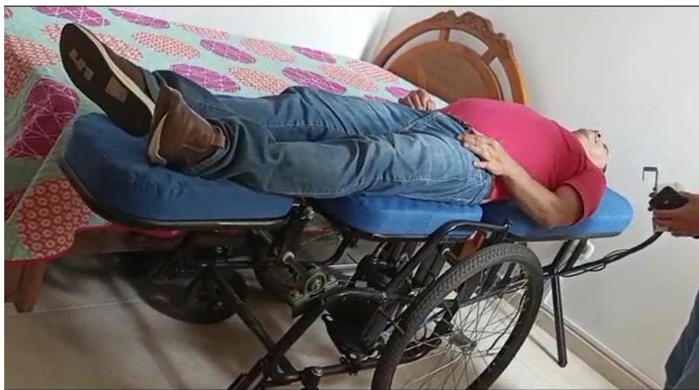
Figura 78. Prueba de usuario mayor con un peso de 80kg usando el mecanismo en posición horizontal.
