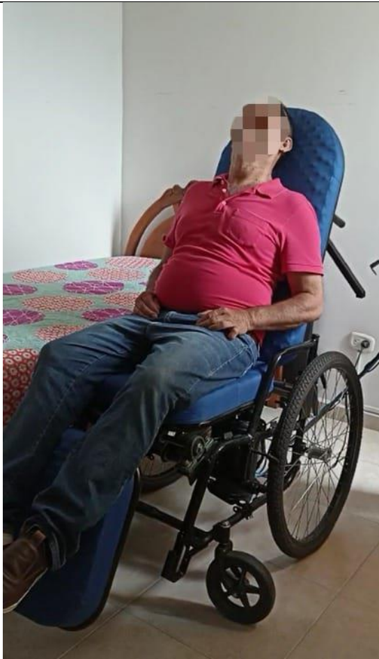
Figura 77. Prueba de usuario mayor con un peso de 80kg usando el mecanismo en posición de silla
