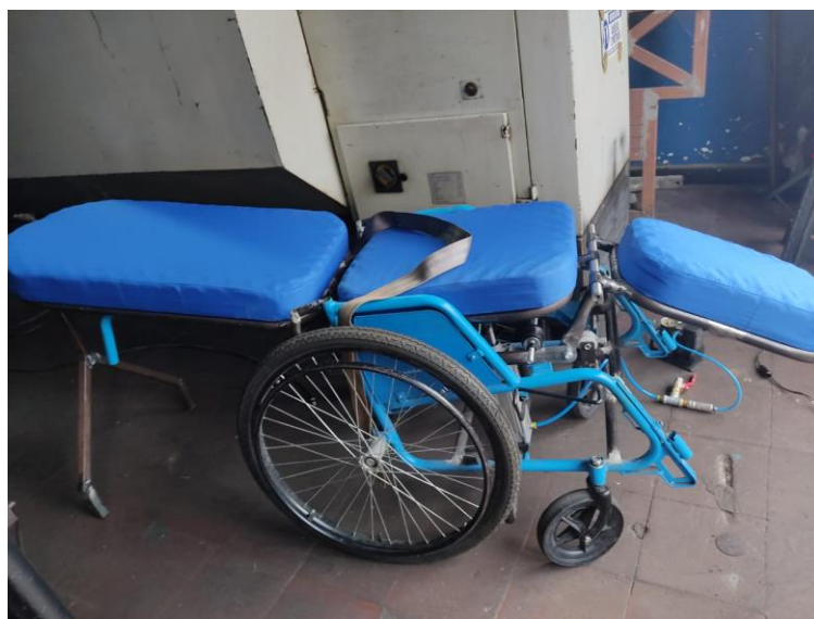
Figura 63. Posición horizontal del mecanismo usando una plataforma de tijeras
