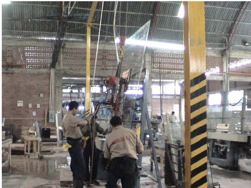
Foto 2. Dispositivos de manipulación del vidrio (para corte).
