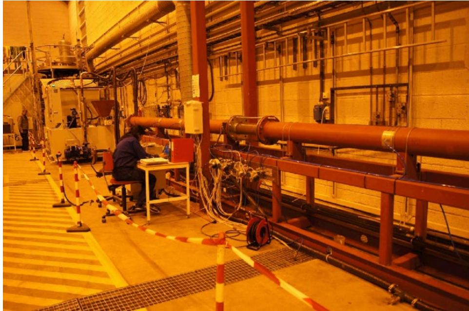
Figura 12. Sistema de flujo en físico de Sayindla, Lund, Ytrehus, Saasen del Departamento de Geociencia y Petróleo de la Norwegian University of Science and Technology. [2]
