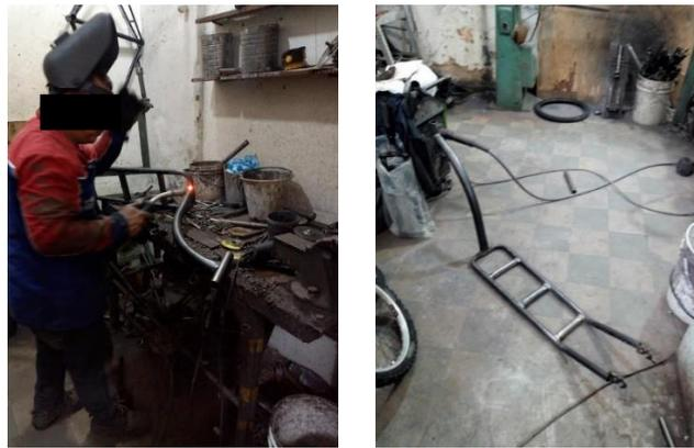
*Figura 51. Incorporación de soportes estructurales en el chasis.*
