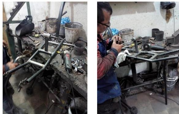
*Figura 52. Instalación de caja pedalier.*
