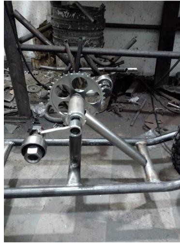
*Figura 60. Refuerzo instalado en el chasis.*
