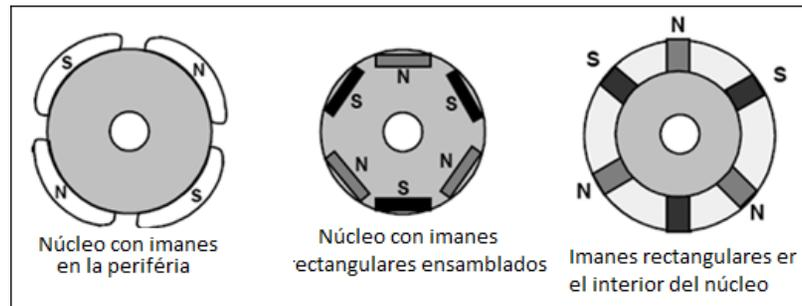
Figura 12. Configuraciones de los imanes en el rotor. [11]
