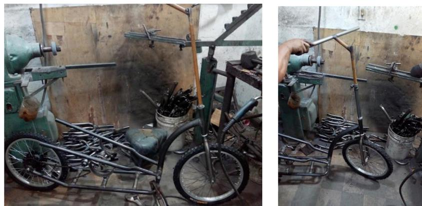
*Figura 59. Fabricación de manubrio y sistema direccional.*
