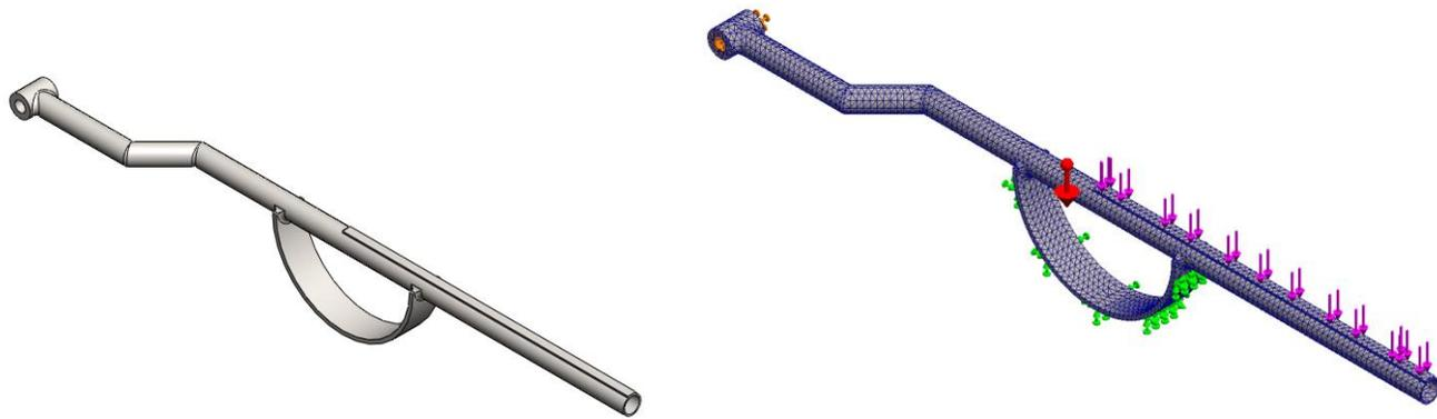
Figura 90. Modelo y mallado del pedal.
