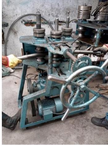
*Figura 48. Cilindradora eléctrica.*
