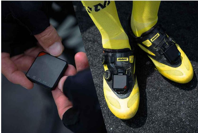
*Figura 6. Sistema de sensores inerciales Leomo. (Leomo, s.f.)*
