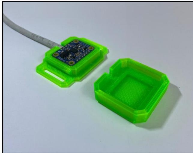
*Figura 21. Sensores inerciales junto a su carcasa*
