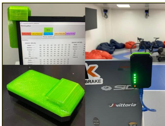
Figura 24. Sistema de soporte para dispositivo Receptor
