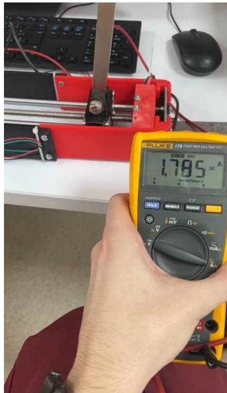
Figura 22. Corriente máxima consumida por el sistema sin peso agregado.
