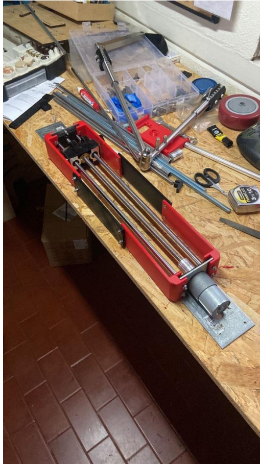
Figura 15. Construcción del sistema activo de corredera que transforma el movimiento rotativo del actuador en movimiento lineal.
