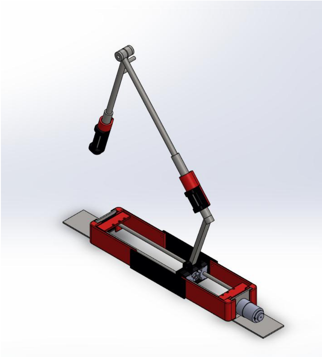
Figura 5. Diseño CAD final del sistema electromecánico.
