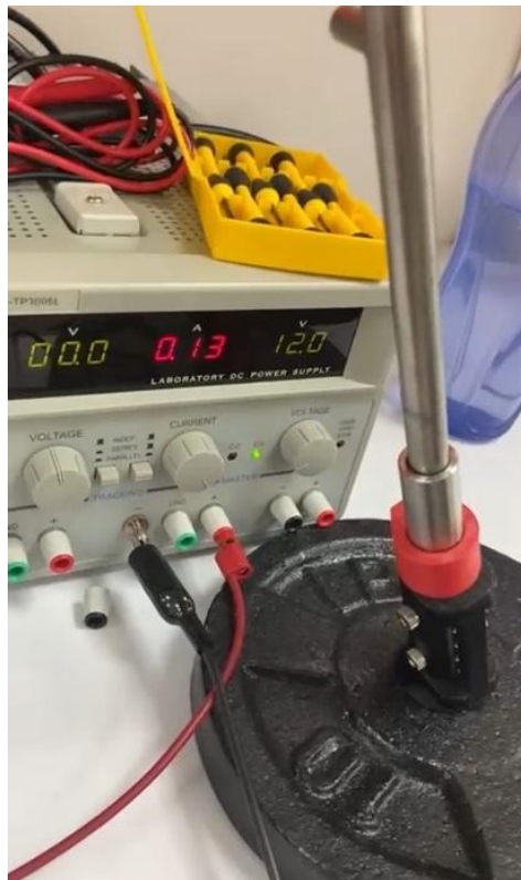
Figura 21. Fuente de voltaje variable a 12 V para la realización de pruebas de peso y de consumo eléctrico.
