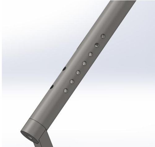
Figura 7. Vemos a detalle algunas secciones del sistema de barras, en este caso se observa un sistema de ajuste tipo telescopio para que se permita una ergonomía mayor según la estatura y longitud de los miembros de los pacientes.
