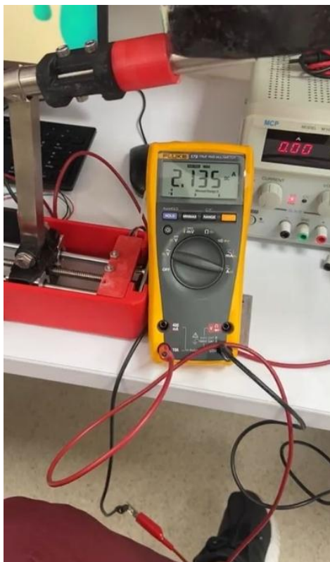
Figura 24. Corriente máxima consumida por el sistema con 10Kg de peso agregado.
