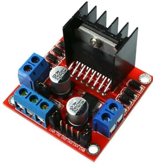
Figura 17. Modulo Puente H L298N para control de motores DC y motores paso a paso.
