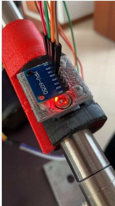
Figura 26. Sensor inercial MPU 6050 en la posición donde toma los datos.
