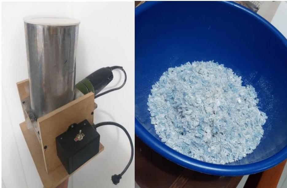
Figura 45. Sistema de triturado y resultado de trituración.
