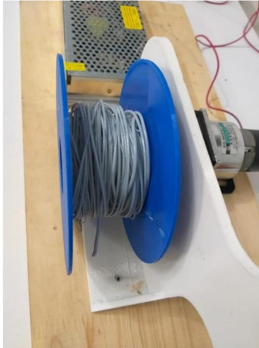
*Figura 58. Filamento extruido y bobinado en un carrete.*
