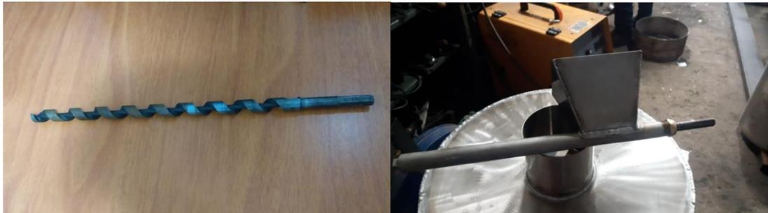
Figura 46. Tornillo tipo barco 3/8" y tolva soldada al cilindro de extrusión.
