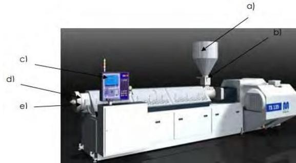
*Figura 10. Máquina extrusora battenfel (Ramos, 2019)*
