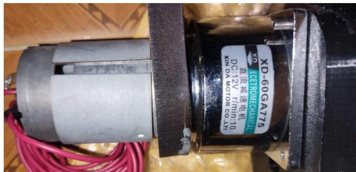
Figura 51. Motorreductor de sistema embobinado.
