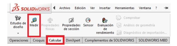
*Nota*. Las herramientas de medición de SolidWorks permiten la obtención de medidas de cualquier tipo de sólido, modelo, malla o superficie.
