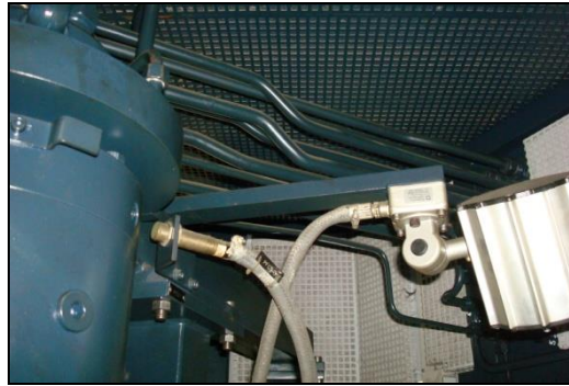
Figura 53. Sensor inductivo acoplado al árbol de la mesa central. Fuente: Autores.
