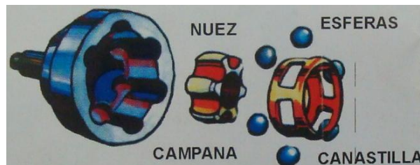
Figura 3. Componentes internos de una junta homocinética.
