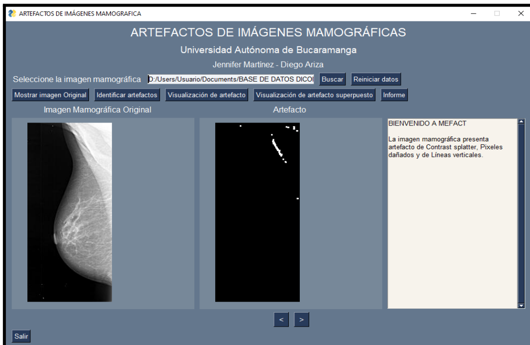
Fig. 24. Visualización de la imagen binaria con el artefacto clasificado del “Sistema de detección y clasificación de artefactos asociados a las imágenes mamográficas”. Fuente. Autoría propia.
