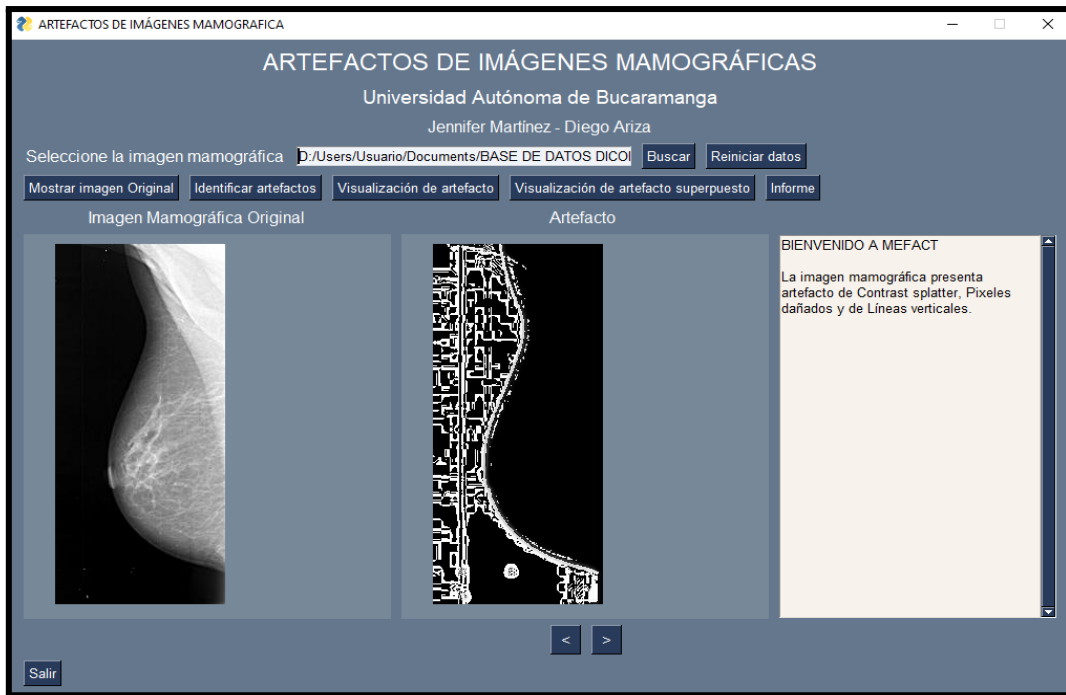
Fig. 25. Visualización de la imagen binaria con el artefacto clasificado del “Sistema de detección y clasificación de artefactos asociados a las imágenes mamográficas”. Fuente. Autoría propia.
