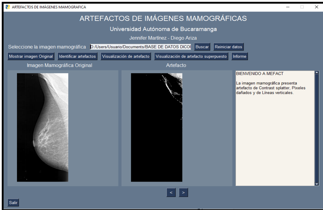
Fig. 23. Visualización de la imagen binaria con el artefacto clasificado del “Sistema de detección y clasificación de artefactos asociados a las imágenes mamográficas”. Fuente. Autoría propia.
