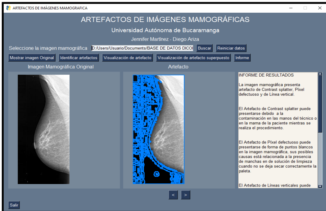
Fig. 29. Visualización de informe de resultados “Sistema de detección y clasificación de artefactos asociados a las imágenes mamográficas”. Fuente. Autoría propia.
