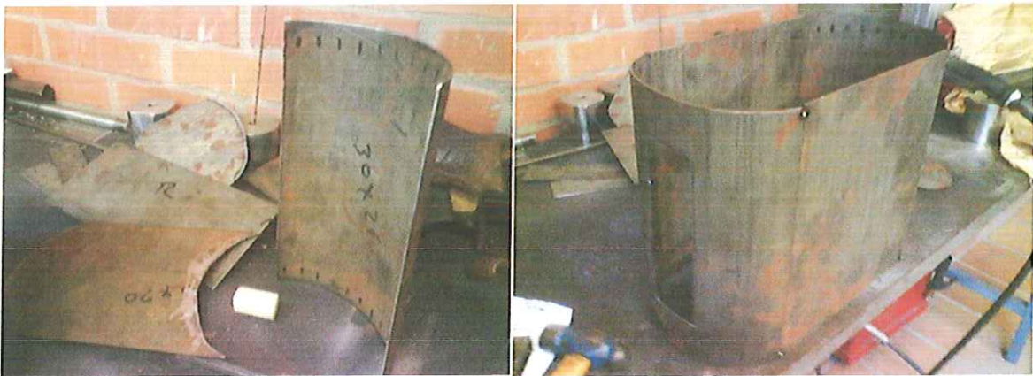
Figura 40: Láminas curvas para la tolva de pesaje
