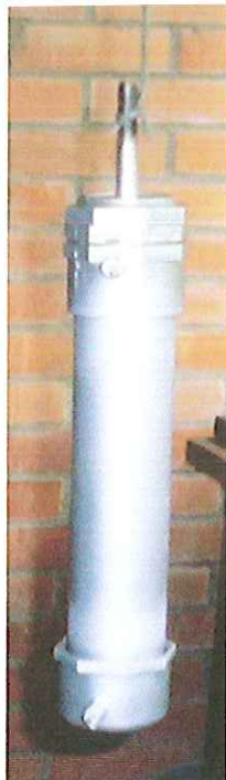
Figura 43: Pistón neumático construido artesanalmente
