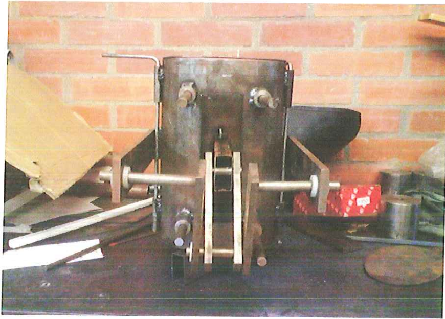
Figura 42: Mecanismo de compactación bloqueado
