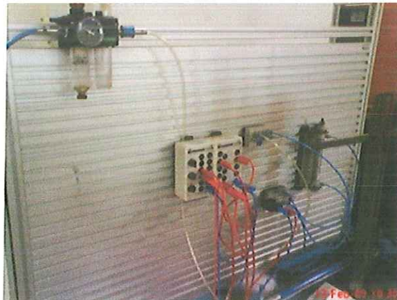
Figura 23: Mecanismo Y Circuito Electro-neumático Del Sistema para la prueba de compresión
