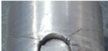
Figura 1 Fractura en eje industrial Extraído de “Fallas por fractura en ejes de alta potencia”
