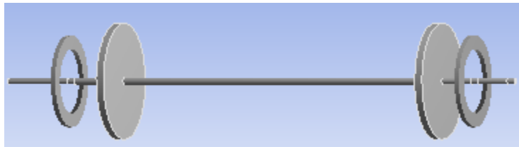
Figura 36 Vista lateral del eje con rodamientos
