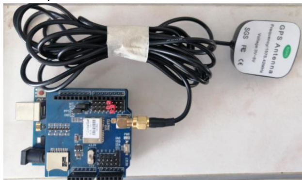
Figura 54. Conexión final para toma de datos - ubicación
