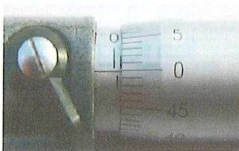
Figura 20. Micrómetro - medida de 4.50 mm
