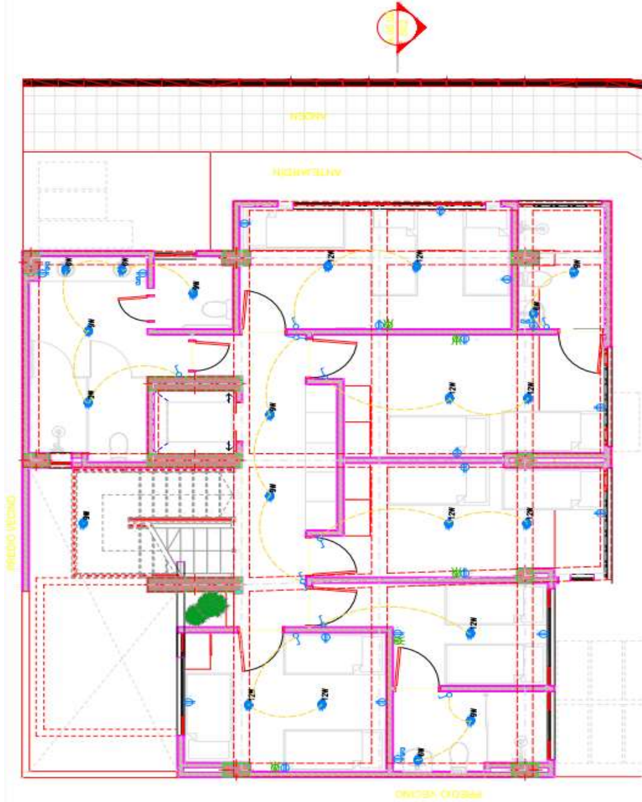
DISTRIBUCIÓN ELÉCTRICA Y COMUNICACIONES PISO TERCERO - 3 ESCALA 1:75
