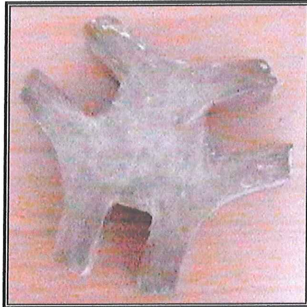
Fig.21 Pieza terminada en resina reforzada con fibra de vidrio
