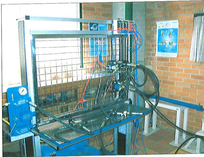
Foto 1. Montaje del circuito hidráulico
