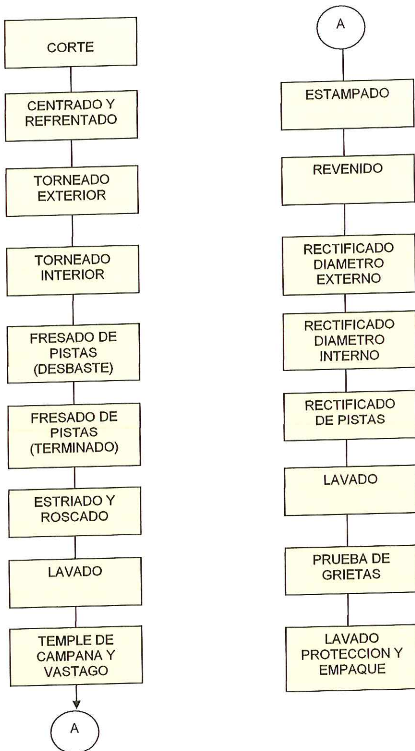
Figura 31. Proceso de Junta fija
