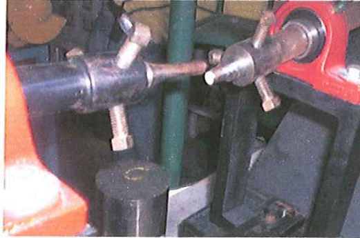
Grafica No 34. Probeta para ensayo de fatiga diámetro 8.89mm
