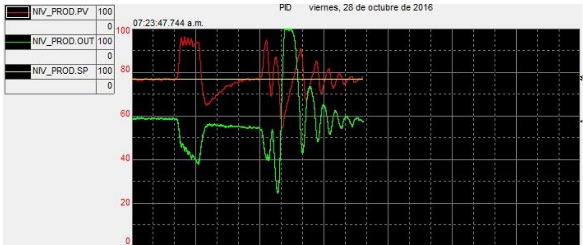
Figura 10 Respuesta lazo cerrado antes de modificar PID
