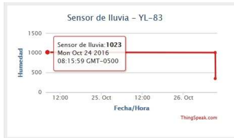
Figura 15: Valor de 1023 visualizado por ThingSpeak cuando la tarjeta está completamente seca.
