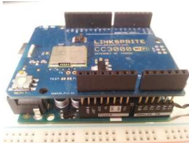
Figura 22: Shield de comunicación WiFi ubicada sobre la tarjeta Arduino Uno.
