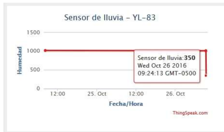
Figura 17: Valor de 350 visualizado por ThingSpeak cuando la tarjeta detecta cierta cantidad de agua.
