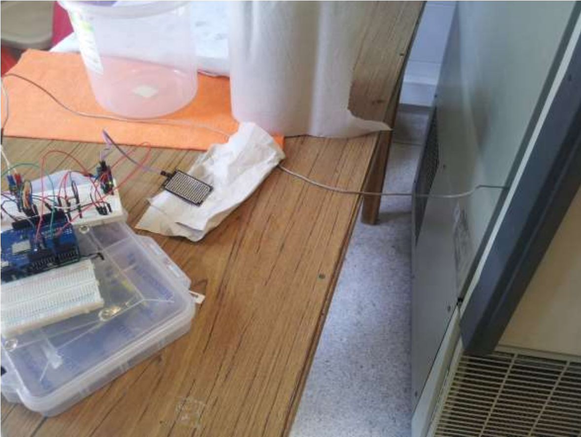
Figura 31: Prototipo del sistema de monitoreo realizando pruebas. El sensor de lluvia se encuentra sobre una servilleta, luego de haber pasado la prueba de agua.
