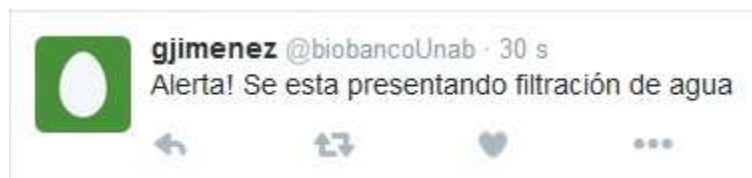
Figura 9: Notificación generada por ThingSpeak, de acuerdo a un evento presentado en el sensor de lluvia, enviado posteriormente a Twitter.
