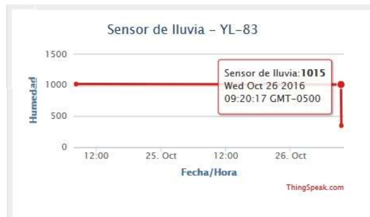
Figura 16: Valor de 1015 visualizado por ThingSpeak cuando la tarjeta detecta humedad del entorno donde se encuentra.
