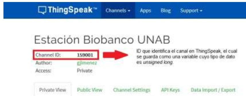
Figura 20: Identificación del canal en ThingSpeak, para el sistema de monitoreo del biobanco.
